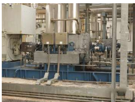
ภาพที่ 2.2-2 (34) การติดตั้งฉนวน เพื่อลดเสียงจากอุปกรณ์
