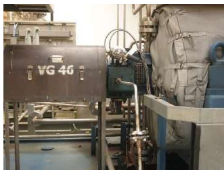
ภาพที่ 2.2-2 (66) ระบบ Shaft Sealing System สำหรับอุปกรณ์ที่มีการหมุน
