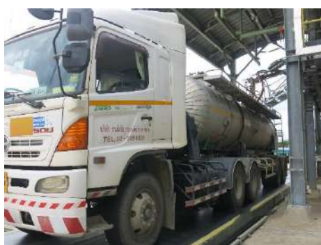
ภาพที่ 2.2-2 (39) ป้ายสัญลักษณ์แสดงระดับความเป็นอันตรายของสารเคมี พร้อมหมายเลขโทรศัพท์ บรรทัดรถบรรทุก วัตถุดิบ/ผลิตภัณฑ์
