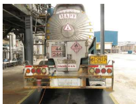
ภาพที่ 2.2-2 (39) ป้ายสัญลักษณ์แสดงระดับความเป็นอันตรายของสารเคมี พร้อมหมายเลขโทรศัพท์ บรรทัดรถบรรทุก วัตถุดิบ/ผลิตภัณฑ์
