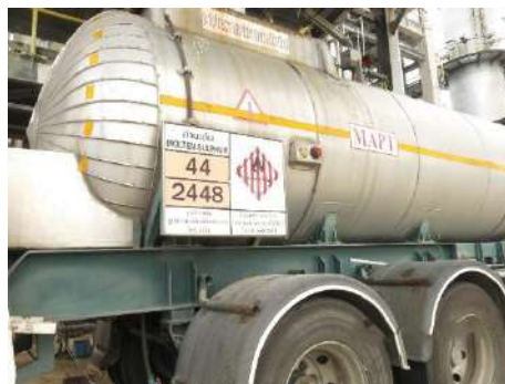
ภาพที่ 2.2-2 (33) ป้ายเตือนอันตราย ระบุชื่อ เบอร์โทรศัพท์ที่ตัวรถบรรทุกทุกภาคของเสียอันตราย
