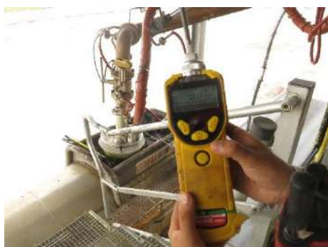
ภาพที่ 2.2-2 (14) การตรวจวัดสารอินทรีย์ระเหย ขณะการสูบล้างสารอินทรีย์ด้วยเครื่องวัดแบบพกพา
